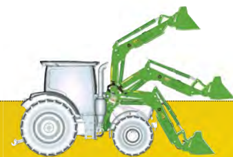
Погрузчик с механическим самовыравниванием (MSL)
