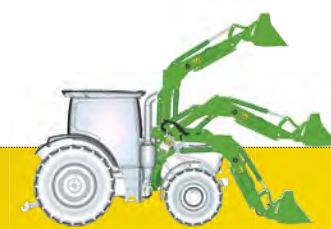
Погрузчик с гидравлическим самовыравниванием (HSL)
